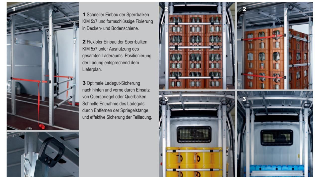
**1** Schneller Einbau der Sperrbalken KIM 5x7 und formschlüssige Fixierung in Decken- und Bodenschiene.
