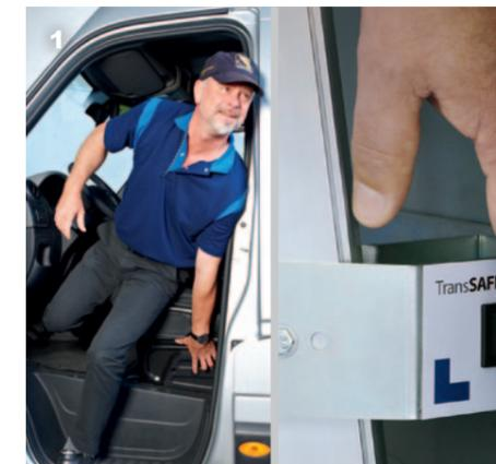
**1** Taste drücken – fertig. Sicherung bzw. Entsicherung des Systems bereits im Fahrerhaus oder im Lade-raum nahe der Schiebe- und Hecktüre. Bei Erreichen der Vorspannkraft schaltet die Systemsteuerung ab. Die Ladung ist flächendeckend gesichert.
