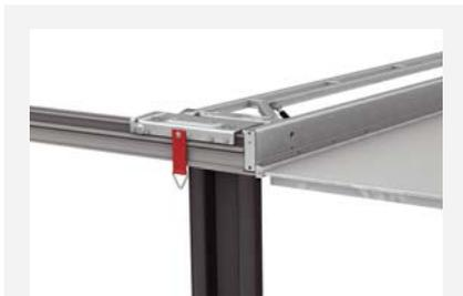
Öffnen der Klappe bei geschlossenem Schiebeverdeck
