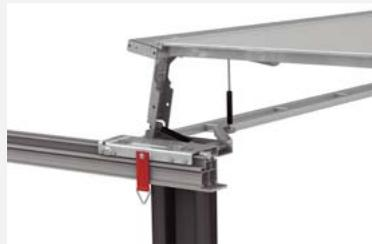
Nach dem Entriegeln des Endholmes kann, ohne die Klappe vorher zu öffnen, der Endholm nach oben geklappt werden. Die Klappe stellt sich automatisch in die waagerechte Position. So kann die Klappe über der Ladebordwand mit dem Schiebeverdeck nach vorne gefahren werden.
